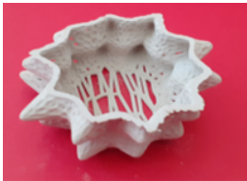
Structure élaborée par injection de liant sur lit de poudre, reproduisant le squelette du corail, utilisée pour l'ensemencement du corail
