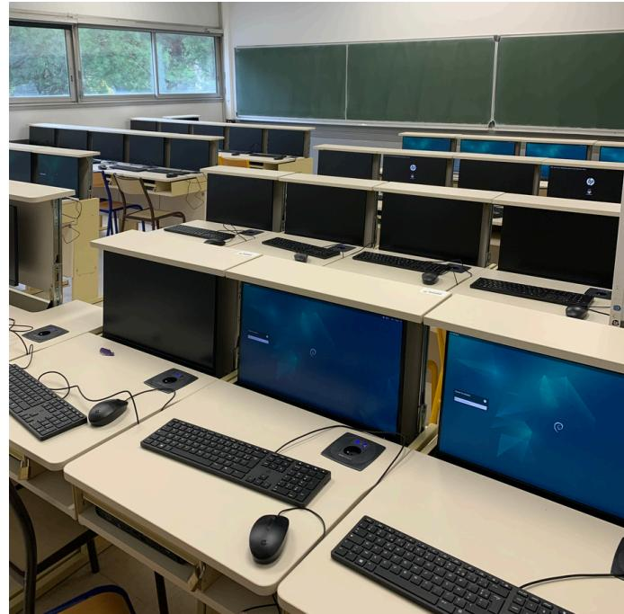
Les 5 salles de TD informatique au 1<sup>er</sup> étage du bâtiment U3 sont maintenant opérationnelles. Ce furent de très gros travaux courants forts et faibles réalisés pour équiper des tables avec PC intégrés et écrans escamotables.
